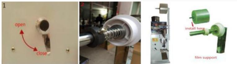
1. Buka paket, dan keluarkan sekrup pendukung dan pengencang. Perbaiki penyangga di sisi kanan mesin.
